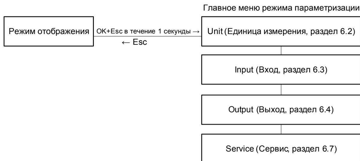
Вы можете вернуться в режим отображения из любого места в меню в режиме параметризации, нажимая клавишу ESC (возможно несколько раз). Если не нажимать никаких клавиш в течение 10 минут, то прибор переключается автоматически в режим отображения.
